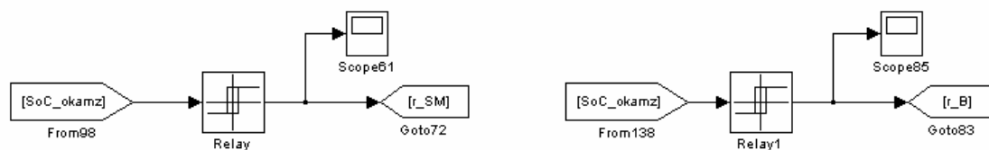
Obrázok 8: Podmienka práce spaľovacieho motora a nabíjania batérií
