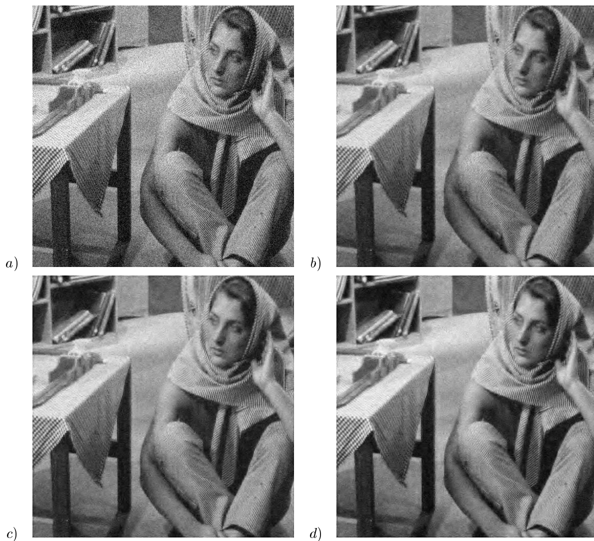
Obr. 4: Ukázky filtrace obrazu barb pro počáteční SNR=15dB (aditivní šum). a) zašuměný obraz a dále filtrace s vlnkami: b) bior2.2 , c) db3 a d) komplexní cdb6 .
