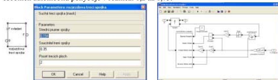
Obrázek 2: Schéma modelu rozjezdové spojky. Vlevo zadání hlavních parametrů. Vpravo detail modelu.
