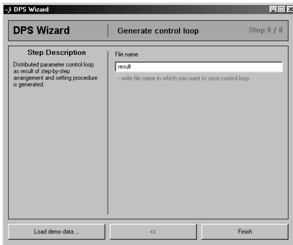
Obr. 10 Záverečné okno - generovanie obvodu riadenia
