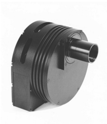
Obr. 1: Astronomická CCD kamera SBIG ST8-E
