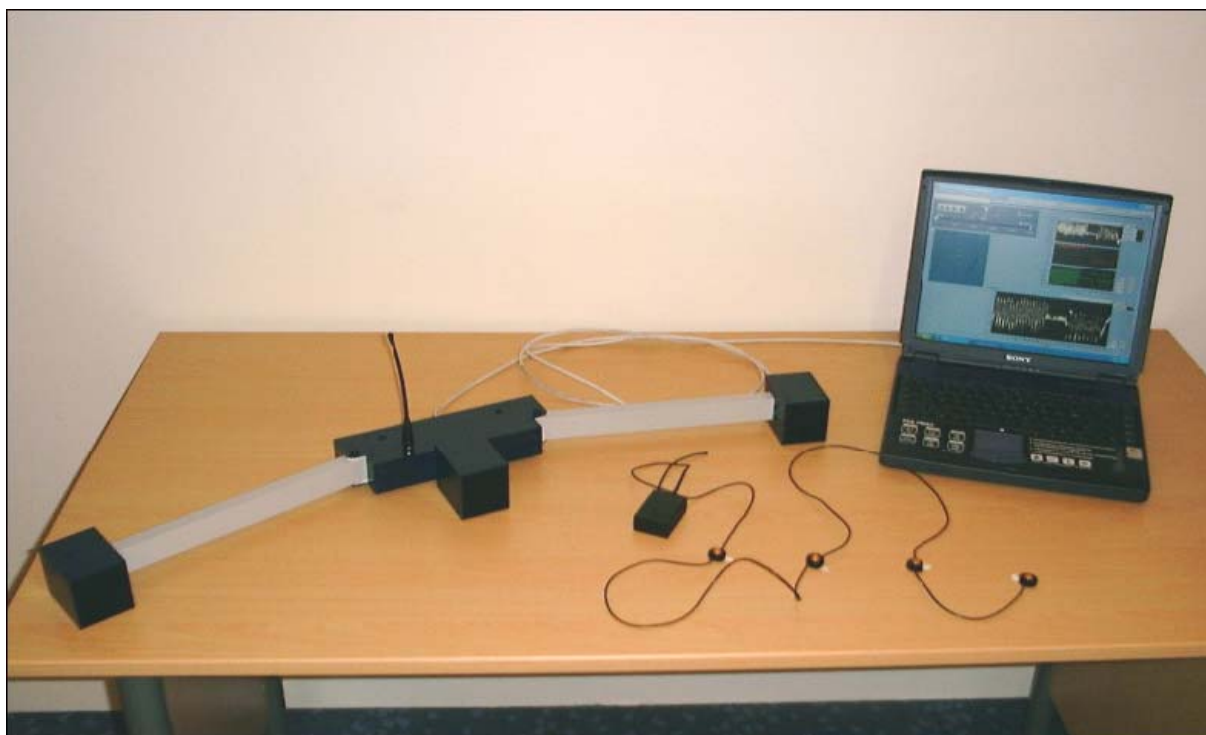
Obr. 1: Kamerový systém LUKOtronic AS 200 na rozevíratelném rameni a bezdrátový vysílač s markery
